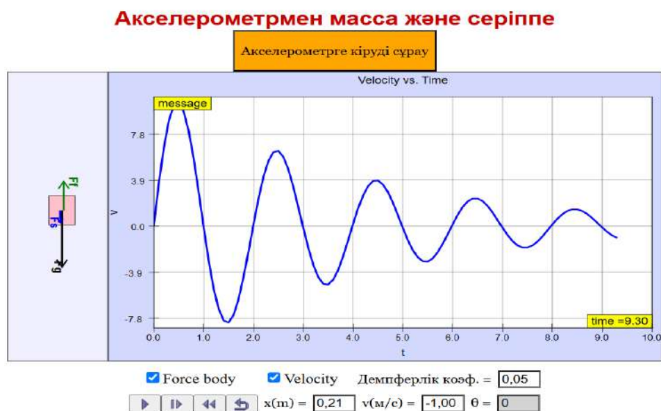
Сурет 1. Массаның вертикаль қозғалысы мен серіппенің тербелісін акселерометр арқылы модельдеу
